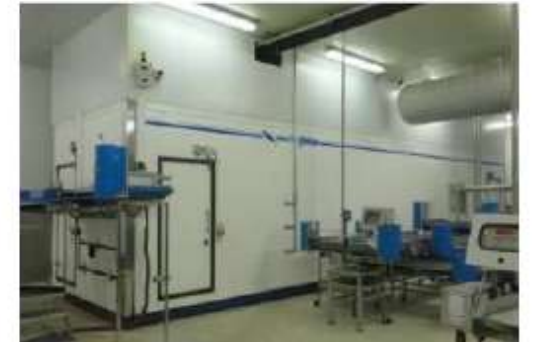
Tunnel de surgélation converti de R404 au R550 Evaporation à -35°C
